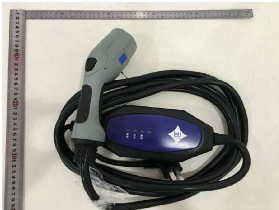
图 11 充电模式 2 的充电插头 (ZM-AH-0216PC)
